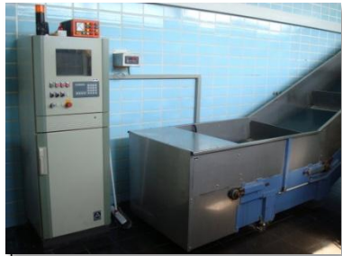
Cinta de carga con balance incorporado
